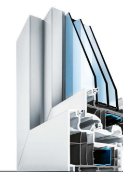
PAST 92 Kunststoff 92 mm Bautiefe U_w bis 0,67 W/m 2 K
