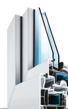
PAST 76 Kunststoff 76 mm Bautiefe U_w bis 0,69 W/m 2 K
