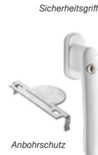
**Die Sicherheitsgriffe** Im abgeschlossenen Zustand ist die Betätigung des Sicherheitsgriffes nicht möglich und daher ein Öffnen des Fensters bei zerstörtem Glas per Durchgreifen nach innen ausgeschlossen. Zusätzlich widersteht der abschließbare Griff einer Krafteinwirkung von 100 Nm.
