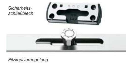
**Die Sicherheitsbeschläge: Stahlharte Sicherheit. Einbruch zwecklos.** Wirksame Eckverriegelungen sowie allseitige Beschläge mit Pilzkopfverriegelungen und Sicherheitsschließblechen am Rahmen sind aus hartem Stahl gefertigt. Der Pilzkopf hinterkrallt beim Schließen das Sicherheitsschließblech.
